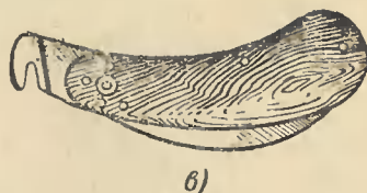
Рис. 19. Ножи для снятия оболочек кабеля. а — типа НКА-1 для алюминиевой оболочки; б — для свинцовой оболочки; в — для пластмассовой.
